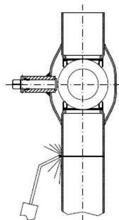
Сварка верхнего шва при закрытом кране должна происходить при наличии воды в кране.
