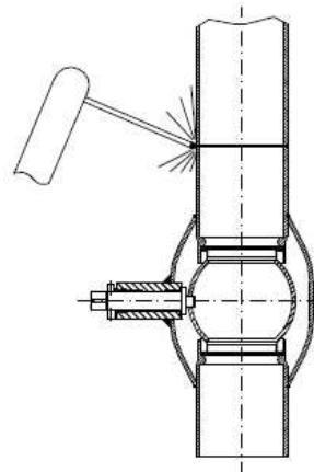
При приварке крана к горизонтальному трубопроводу кран должен быть полностью открытым.
